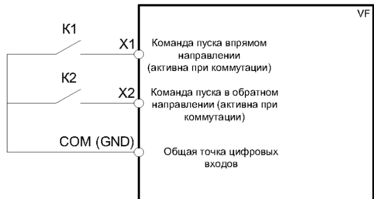
Рисунок 10.9-5 Двухпроводная схема управления 1
