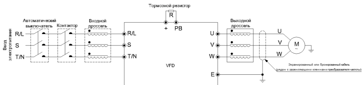
Рисунок 4.4-1 Типовая схема подключения преобразователя частоты
