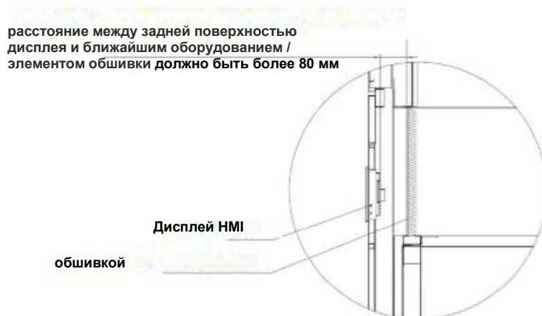
Рисунок 2-17 Безопасное расстояние до задней поверхности дисплея HMI
