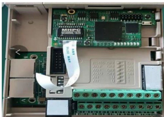
Рис. 7.2 Вариант установки на преобразователях частоты мощностью 2.2кВт-5.5кВт
