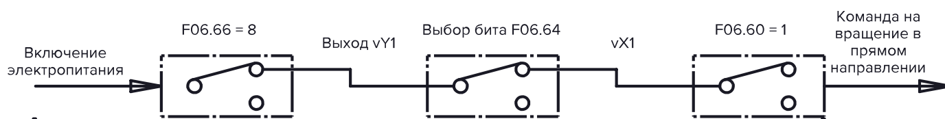
Рисунок 10.10-6 Схема автоматического запуска при включении питания
