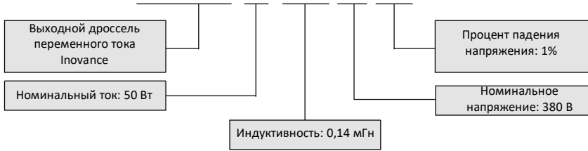
Рисунок 4-34 Модель выходного дросселя переменного тока
