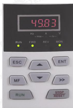
Рис. 2-3 Режим установки значения параметра
