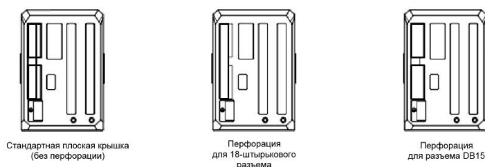
Рис. 3-16. Конфигурация перегородки на плате расширения энкодера
