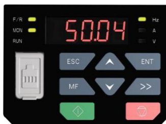
Рис. 4-7. Режим прямого изменения частоты
