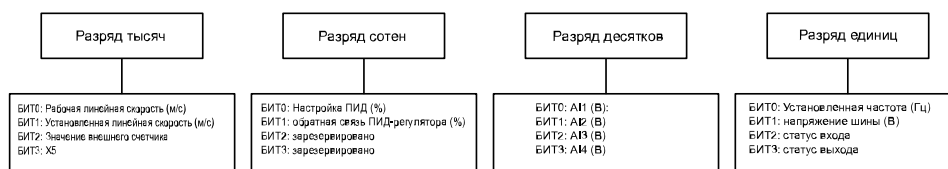
Рис. 4-14. Установка шестнадцатеричного параметра L1-02
