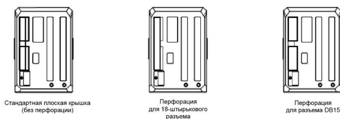
Рис. 3-16. Конфигурация перегородки на плате расширения энкодера
